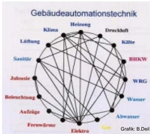
So ist es beispielsweise notwendig, eine Verknüpfung von der Fernwärmestation zur Heizungs- oder Lüftungsanlage herzustellen, damit nur die Energiemenge bereit gestellt wird, die tatsächlich momentan benötigt wird.
